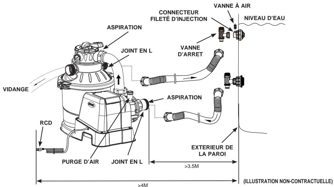
Conformément à la norme internationale, CEI 60364-7-702, pour toute installation électrique de piscine et autres équipements de bassins, les distances d'installations suivantes doivent être respectées :
