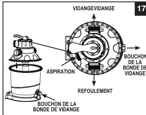
**IMPORTANT** : Il y a trois ports de connexion prévus pour les tuyaux sur la vanne 6 voies, assurez vous que le port de refoulement (de la cuve à la piscine) soit face à la piscine (voir dessin 18).
